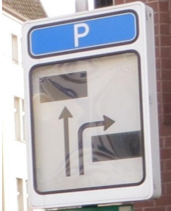
Abbildung 189: Veraltetes, technisch defektes PLS
